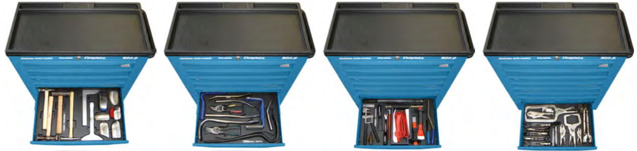
5 o Cajón: Tases y Martillos 6 o Cajón: Palancas + Tijeras 7 o Cajón: Utillajes Carroceria 8 o Cajón: Mordazas Grip
